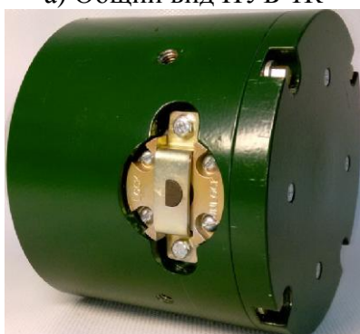
в) Кассета типа СН с излучателем натрия-22
